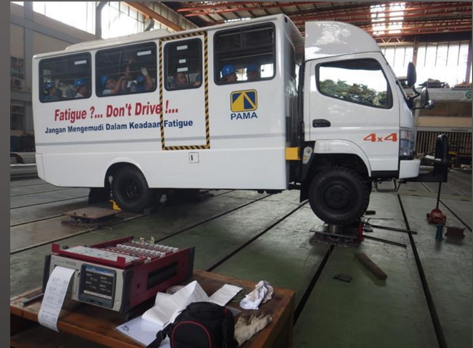
Gambar L1.1. Foto timbangan (load cell) pada posisi roda bagian depan kanan (P1F1) benda uji kendaraan bus.
