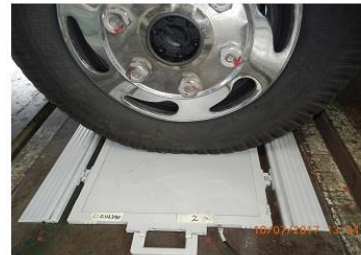
Gambar L1.2. Foto timbangan (load cell) pada posisi roda bagian depan kiri (P2F2) benda uji kendaraan bus.
