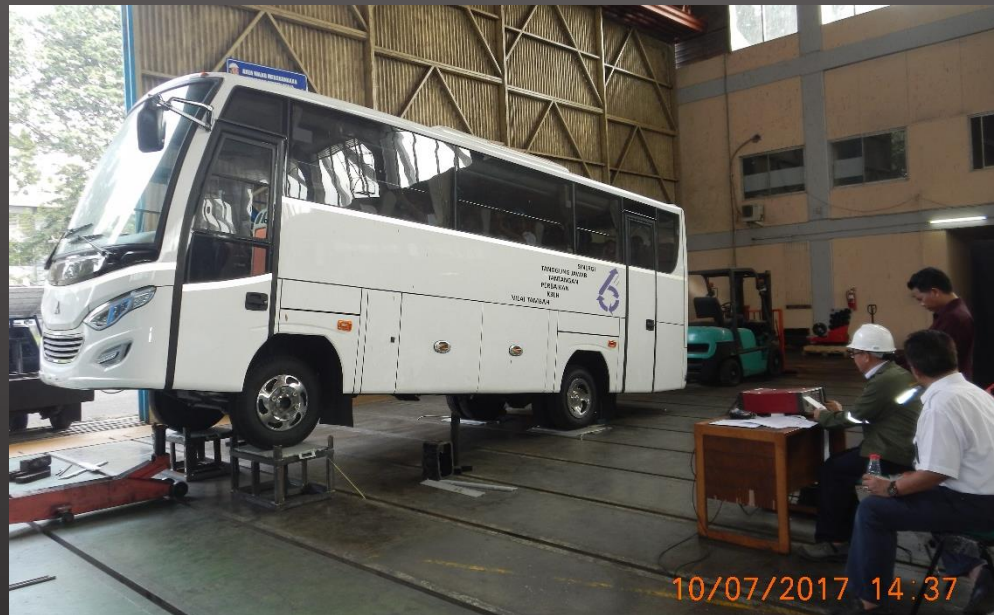
Gambar L1.1. Foto timbangan (load cell) pada posisi roda bagian depan kanan (P1F1) benda uji kendaraan bus.
