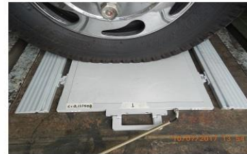
Gambar L1.1. Foto timbangan (load cell) pada posisi roda bagian depan kanan (P1F1) benda uji kendaraan bus.
